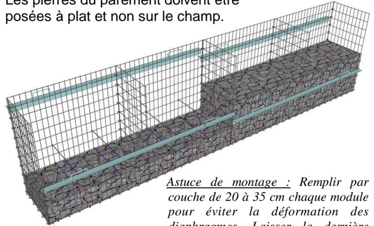
*Astuce de montage :* Remplir par couche de 20 à 35 cm chaque module pour éviter la déformation des diaphragmes. Laisser la dernière cellule vide pour faciliter l'assemblage des nouveaux panneaux.
