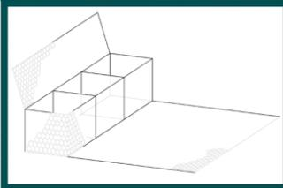
Ce procédé de remblais armés associe un parement en gabion (droit ou en gradins) à des nappes de renforts horizontales qui apportent l'ancrage du parement et le renforcement du massif. Mise en œuvre facile même dans des sites difficiles d'accès. Les éléments d'une largeur de 2, 3 ou 4 m ont une longueur variable, fonction de la hauteur de l'ouvrage, des caractéristiques des sols et des surcharges. Le même procédé se décline avec un parement végétalisable incliné
