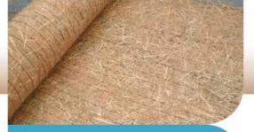
Les bionattes TerraMat® sont constituées d'un enchevêtrement de différentes fibres végétales (paille, coco ou mélange paille+coco) maintenues par deux micro filets (polypropylène photodégradable ou jute biodégradable) cousus entre eux.
