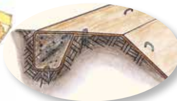
DÉTAIL DE FERMETURE DE LA TRANCHEE DE TÊTE
