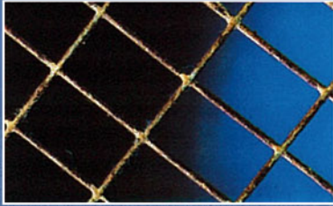
Treillis galvanisé après tests de 5 ans
