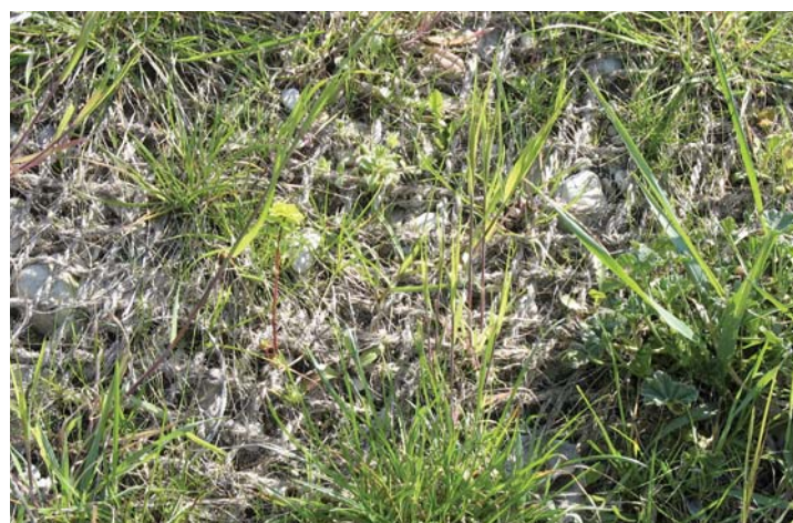
Géofilets coco avec mailles de 8 à 15 mm (740 ou 900 g/m 2 ).
